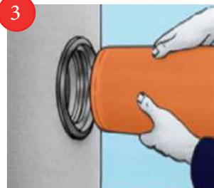
POSTERIORMENTE Y CON APOYO DE LA GRÚA MANIPULAR EL TANQUE PARA LOGRAR SU ALINEACIÓN AL OTRO EXTREMO DEL TUBO COLOCANDO EL EMPAQUE CORRESPONDIENTE, APLICANDO LA GRASA O ACEITE LUBRICANTE E INTRODUCIR EL TUBO HASTA QUE QUEDE AL RAS CON LA PARED INTERIOR. SE RECOMIENDA SELLAR CON SILICÓN O ALGÚN PRODUCTO DE POLIURETANO LAS PAREDES INTERNAS DE LA INTERCONEXIÓN PARA ASEGURAR LA HERMETICIDAD DE LAS UNIONES.
