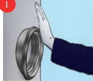
DESPUÉS DE BAJAR EL PRIMER TANQUE SE PROCEDE A COLOCAR LA JUNTA FLEXIBLE EN LA PERFORACIÓN Y POSTERIORMENTE SE APLICARA GRASA EN CANTIDAD SUFICIENTE AL INTERIOR DEL MISMO PARA INTRODUCIR EL TUBO DE INTERCONEXIÓN.
