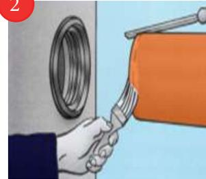
A CONTINUACIÓN, SE TOMA EL TRAMO DE TUBO DE PVC Y SE RECOMIENDA BISELARLO EN AMBOS EXTREMOS PARA EVITAR LASTIME EL EMPAQUE Y FACILITE SU COLOCACIÓN. SE COLOCA GRASA EN EL EXTREMO A INTRODUCIR Y SE INSERTA EN EL EMPAQUE HASTA EL TOPE DEL CONECTOR.
