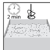
Mezcle manualmente hasta obtener una consistencia uniforme, o durante dos minutos a baja revolución (500 rpm) si es un equipo mecánico.
