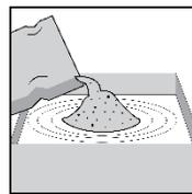
Agregue Concreto R-150 al recipiente con agua de forma progresiva, evitando que se hagan grumos.
