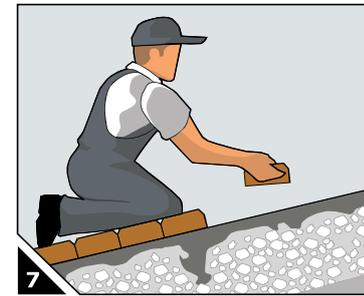
Al colocar Euroadoquín sobre plano inclinado, siempre debe hacerse en hiladas de abajo hacia arriba.
