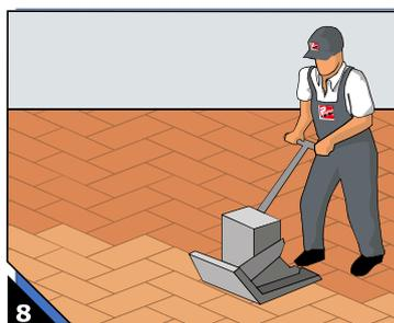
Se recomienda compactar la superficie adoquinada protegiendo el equipo con un recubrimiento de goma para evitar dañar las piezas. En las orillas no debe aplicarse, para impedir que las piezas se separen del borde.
